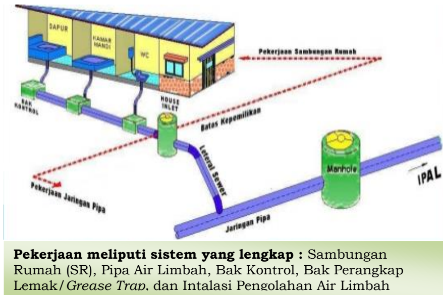
Gambar 1. Contoh Modul Jaringan Perpipaan Air Limbah Skala Komunal dan Prasarana Pelengkap
