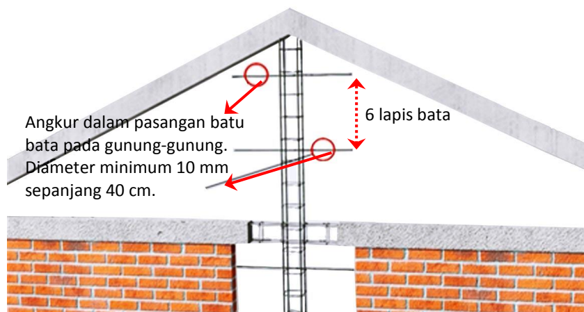
Gambar 52. Hubungan Angkur Pada Gunung-Gunung/ Ampig
