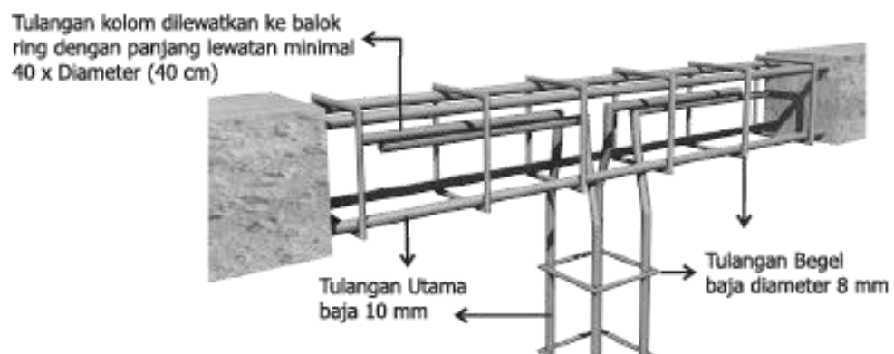
Gambar 48. Hubungan Anatar Kolom dengan Balok Keliling/ Ring
