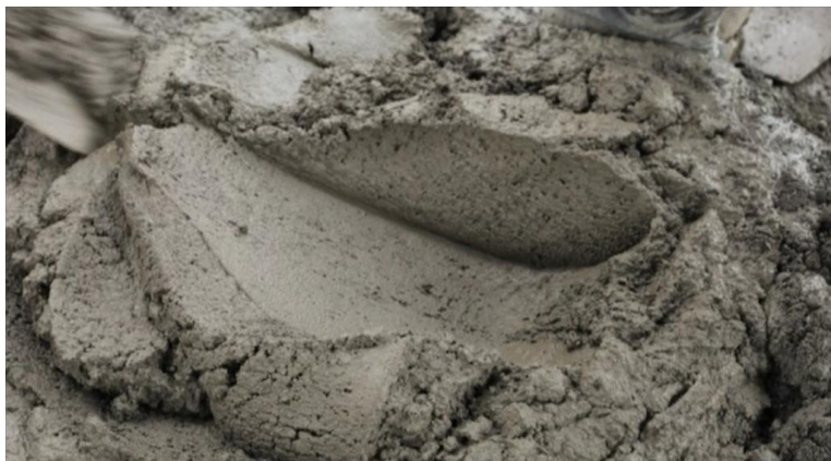
Gambar 9. Hasil Pencampuran Mortar Yang Baik
