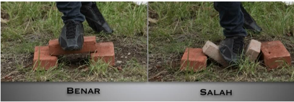
Gambar 13. Pengujian Sederhana Kekuatan Batu Bata
