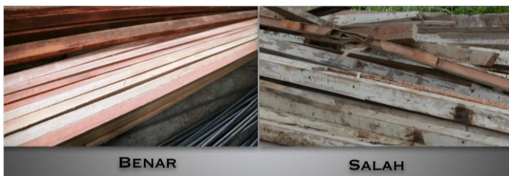
Gambar 16. Kayu Yang Baik Digunakan Dalam Pembangunan
