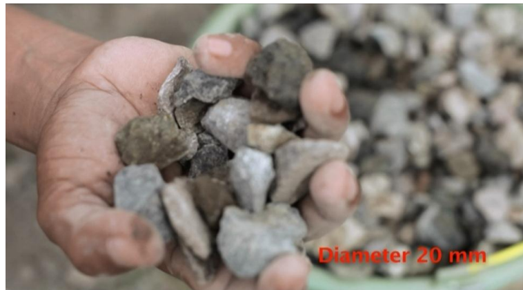
Gambar 5. Diameter Kerikil Yang Baik Untuk Campuran Beton
