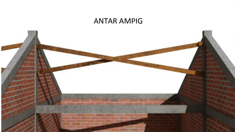
Gambar 35. Ikatan Angin Sebagai Pengikat Antar Gunung-Gunung/ Ampig
